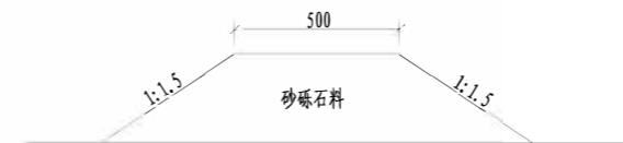
高喷灌浆施工平台典型断面图
